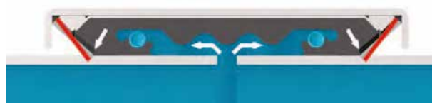
Effet progressif d'ancrage
